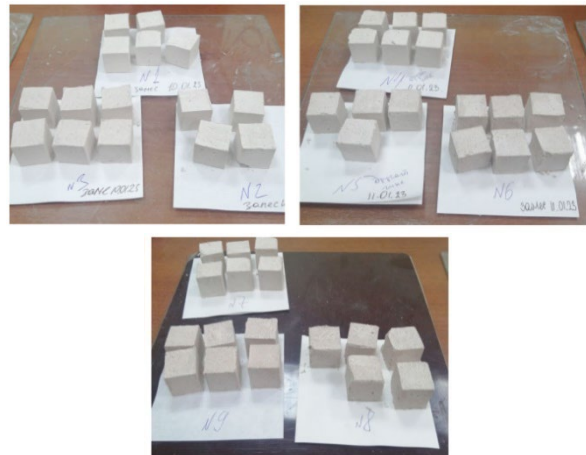
Рис. 5. Изготовленные образцы композиционного материала
